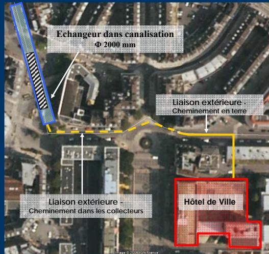
L'échangeur de 60 m sera installé dans la canalisation placée sous la place du Hainaut
